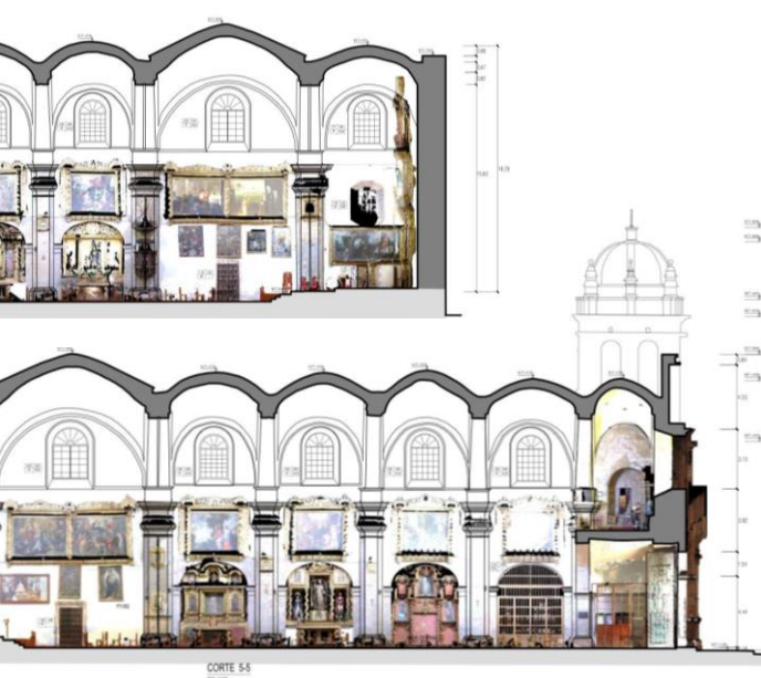
Fig3_Tavole CAD con ortofoto ad alta risoluzione
